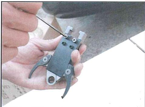
5. Afloje el tornillo (501) con un desatornillador plano. Quite la manija (002) y el mecanismo de acoplamiento.
