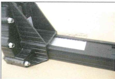
3. Para un cerrado fuerte es necesario que las grapas queden bien cerradas hasta el final de la caja. Revise los requerimientos del empaque. Realice pruebas en caja de muestra.
