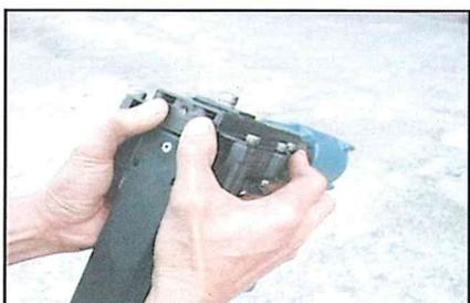
2. Empuje el cuerpo (001) hacia arriba y ajuste a la profundidad deseada.
