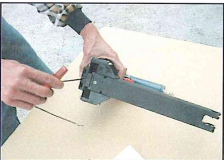
3. Afloje el tornillo de presión (504) con la llave hexagonal de 3 mm para abrir el ajuste de la barra.
