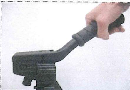
2. Coloque la caja en la posición deseada para la colocación de la grapa. Hay una pequeña protección en cada una de las partes del asiento del compartimiento (032) como ayuda para localizar la posición de la grapa. Mantenga el extremo delantero de la herramienta presionado en la tapa del cuerpo (001). Presione hacia abajo la manija (002) todo el camino hasta que pare. Suelte la manija (002) y coloque la herramienta en su siguiente posición.
