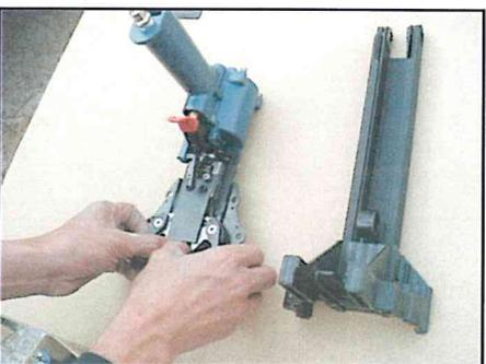
4. Quite el mecanismo del acoplamiento y de la barra de ajuste (012) simultáneamente del cuerpo (001).
