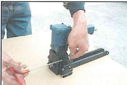
1. Afloje los tornillos (508,509) y la tuerca (520) con la llave de tuercas de 8 mm y de la llave hexagonal de 4 mm.
